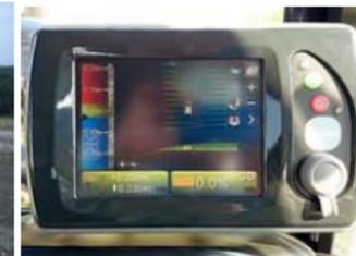
ブルドーザの位置、仕上げ面がモニターで確認可能
